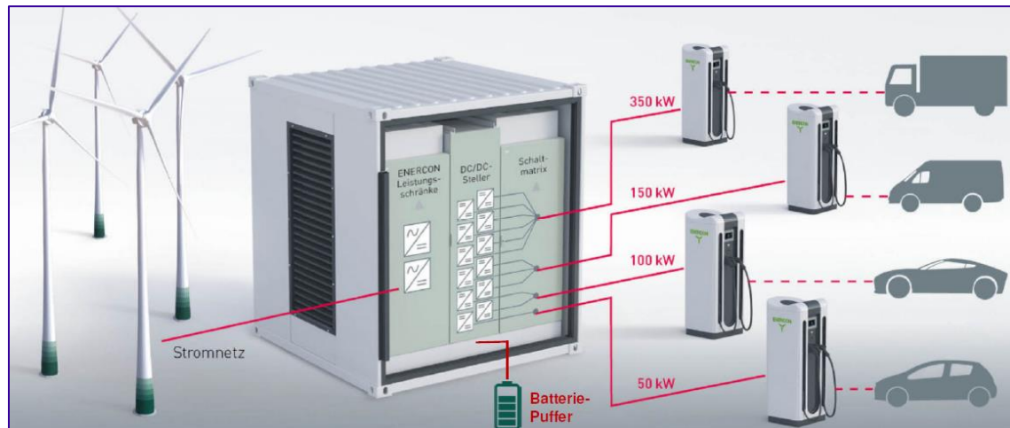
Abbildung 43: Schematische Darstellung des modularen Schnellladesystems (Enercon 2018).
